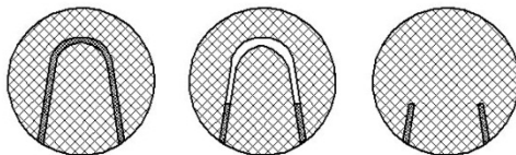
Рис. 6.1. Принцип действия яркостных пирометров
