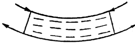
Рис. 4.1. Схема деформации изгиба стержня
