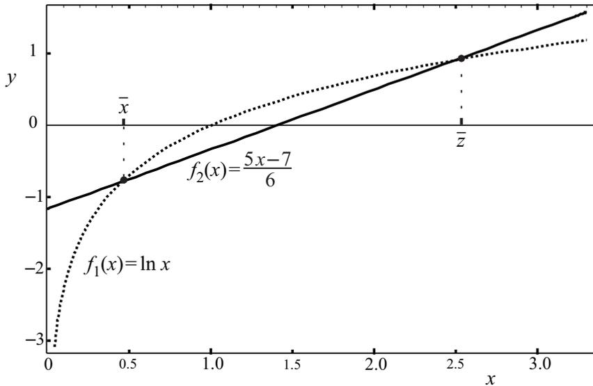
Рис. 11. Графическое отделение корней<sup>13</sup>
