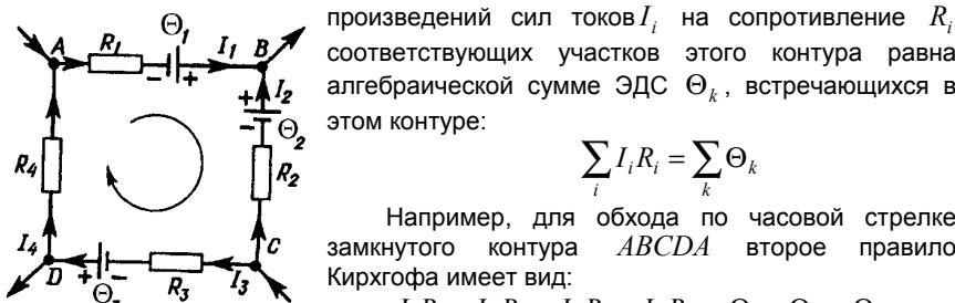
Например, для обхода по часовой стрелке замкнутого контура  $ABCDA$  второе правило Кирхгофа имеет вид:
